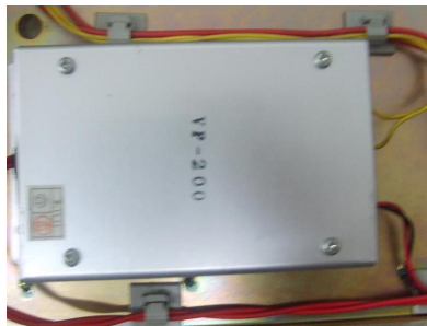
자외선 램프 콘트롤 BOX
